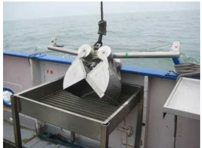
Abb. 1: Darstellung der wichtigsten Probenahmegeräte, des Sammelrahmens (links) für die Taucharbeit und des Van-Veen-Greifers (rechts) für die schiffsgestützte Beprobung.
