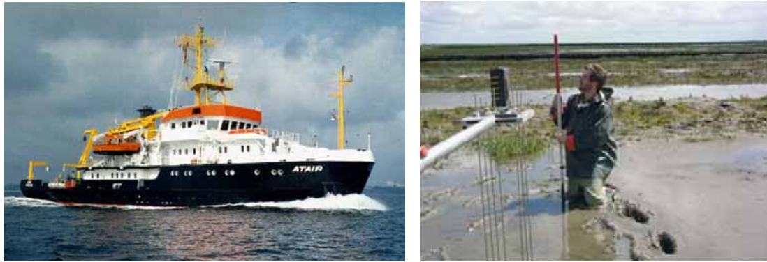
Abb. 3: Verfahren der bathymetrischen Vermessung: Tiefenpeilung mit Schiffen (BSH, links) und terrestrische Messmethoden (rechts).
