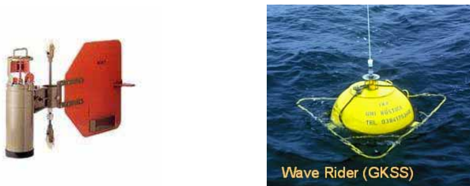
Abb. 2: Messgeräte der marinen Hydrologie (links Strömungsmesser der Firma Aanderaa, rechts eine Wave Rider Boje, die Wellenhöhe und -richtung erfasst).
