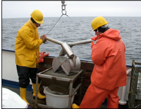
Abb. 1: Van-Veen-Greifer im Einsatz
