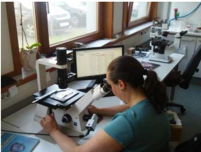
Abb. 1: Analyse einer Planktonprobe am Inversmikroskop mit der Online-Zählsoftware OrgaCount.
