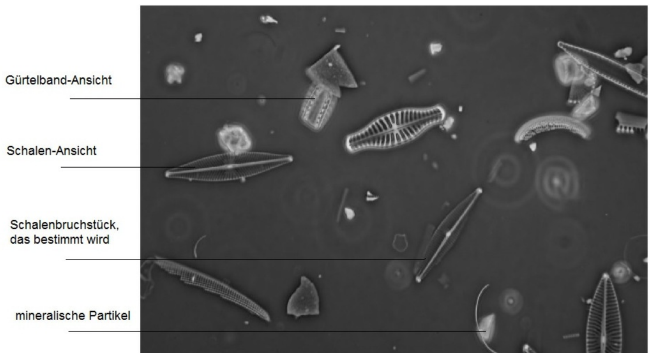
Abb. 1: Ausschnitt eines Gesichtsfelds bei der Diatomeenbestimmung (Phasenkontrast, 1000-fach).
